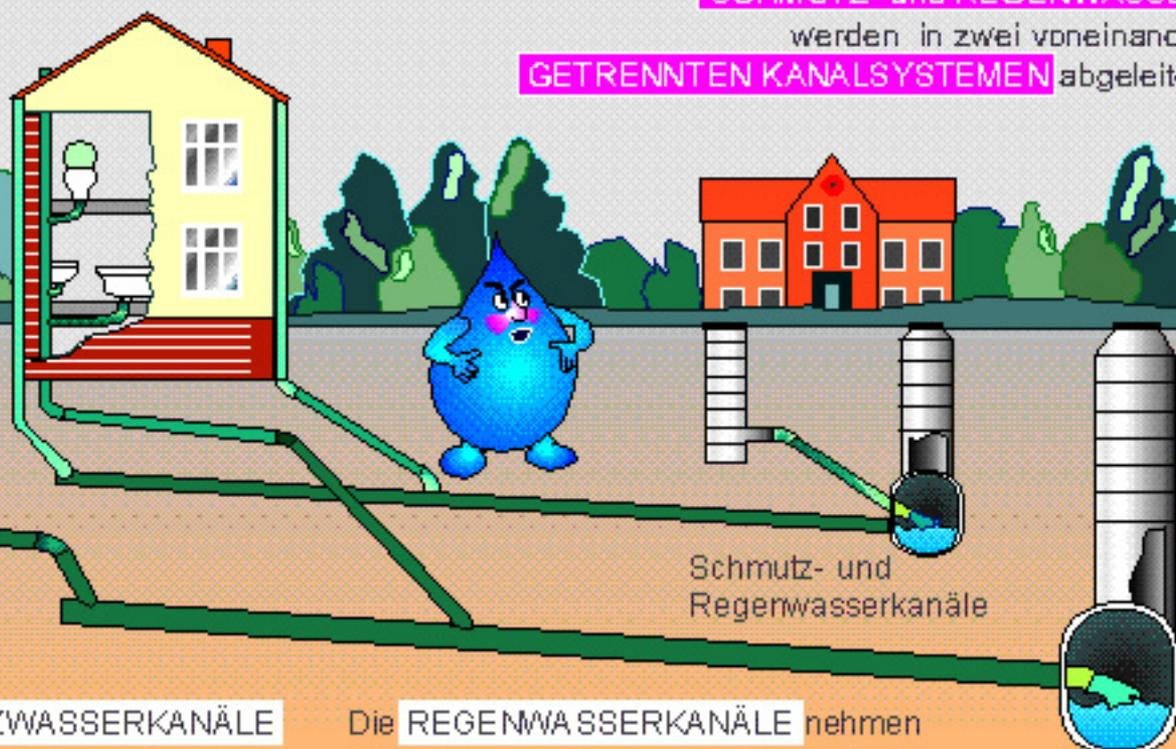
Die **SCHMUTZWASSERKANÄLE** leiten das Abwasser zu den Pumpwerken, die es zu den Klärwerken befördern.
